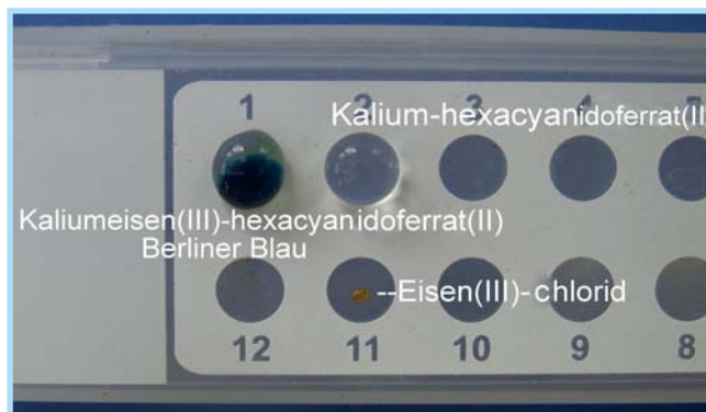
Abb. 12. Nachweis von Eisen(III)-ionen mit Kaliumhexacyanidoferrat(II)
