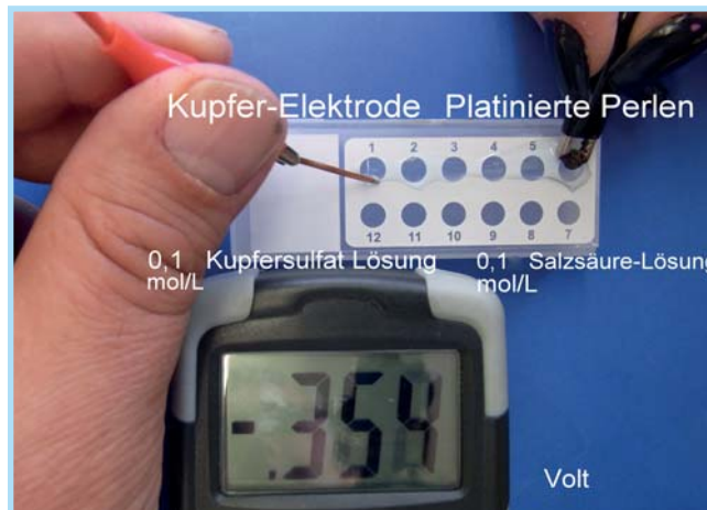
Abb. 9. Normalwasserstoffelektrode mit Platinierten Perlen
