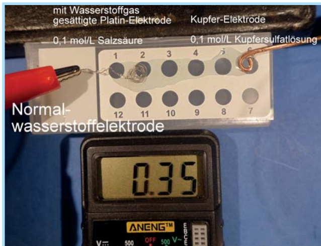
Abb. 6. Messung mit einer Normalwasserstoffelektrode
