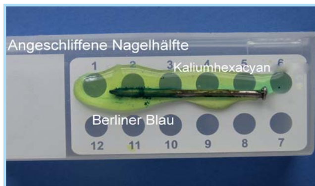
Abb. 14. Korrosion von Eisen
