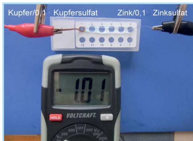
Abb. 3. Die Kupfer Halbzelle und Zink Halbzelle
