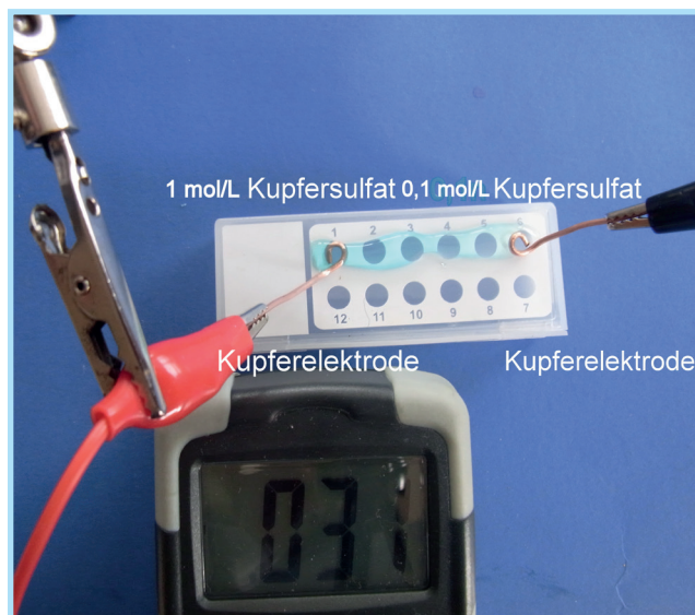
Abb. 2. Halbzellen mit unterschiedlicher Kupfersulfat Konzentrationen
