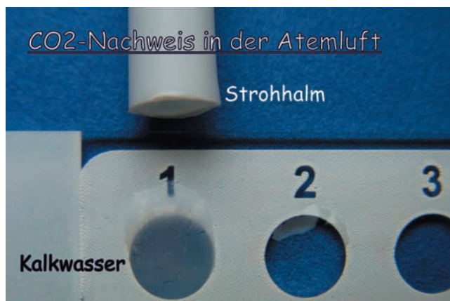
Abb. 11. Nachweis von Kohlenstoffdioxid in einem Calciumhydroxid-tropfen.
