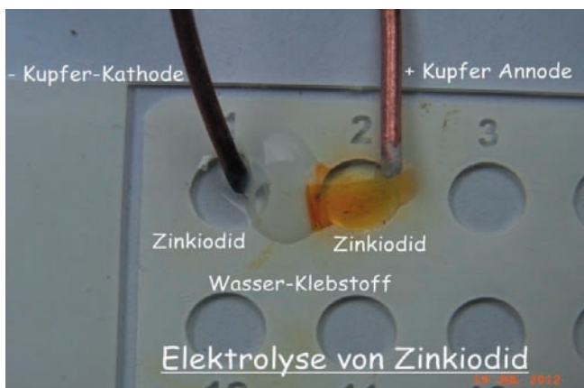
Abb. 17. Die Elektrolyse von Zinkiodid bei 9 V Gleichstrom.
