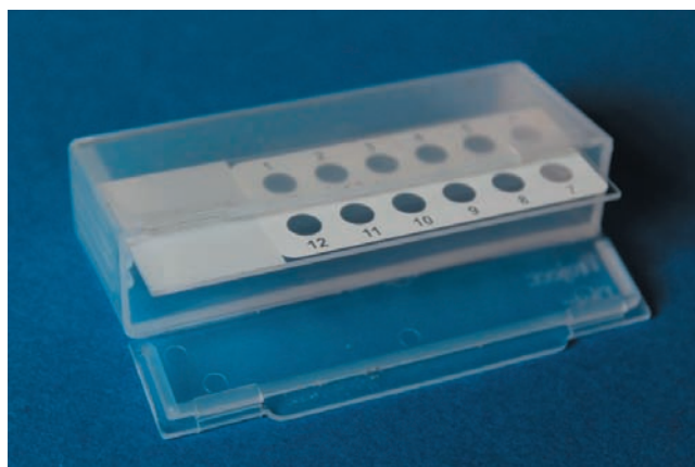
Abb. 6. Die T-OT Box mit verschiedenen Höheneinstellungen.
