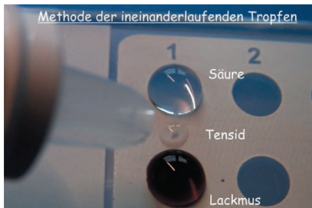
Abb. 12. Nachweis der Säure mit Lackmus nach der Indetro Methode.
