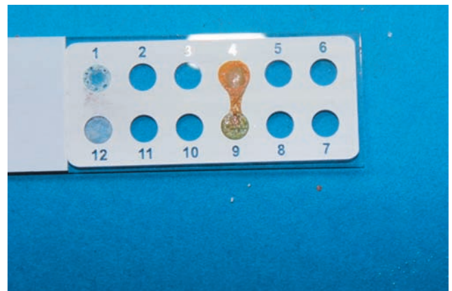
Abb. 21. Der Zuckernachweis mit Fehlingscher Lösung I und II.
