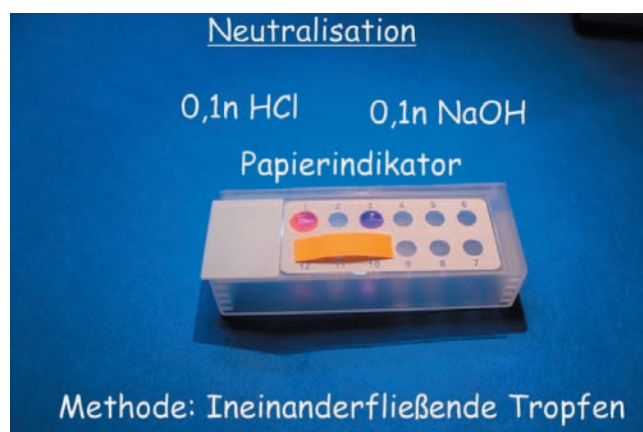
Abb. 14. Neutralisation von NaOH ( c = 0,1 \text{ mol} \cdot \text{l}^{-1} ) mit HCl ( c = 0,1 \text{ mol} \cdot \text{l}^{-1} ) – (Flütro-Methode)
