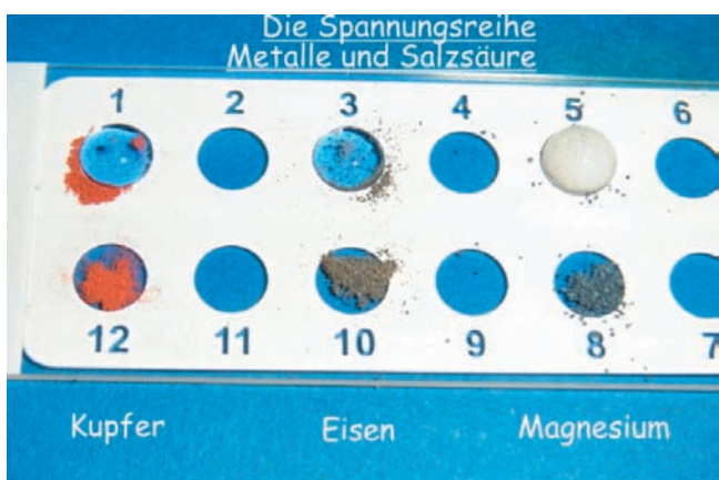
Abb. 16. Edle und unedle Metalle (Cu 1, Fe 3, Mg 5).
